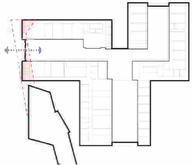
Figuur 17: het verwijderen van de P2 laagbouw (rood gestippeld) waardoor de alzijdigheid wordt hersteld
