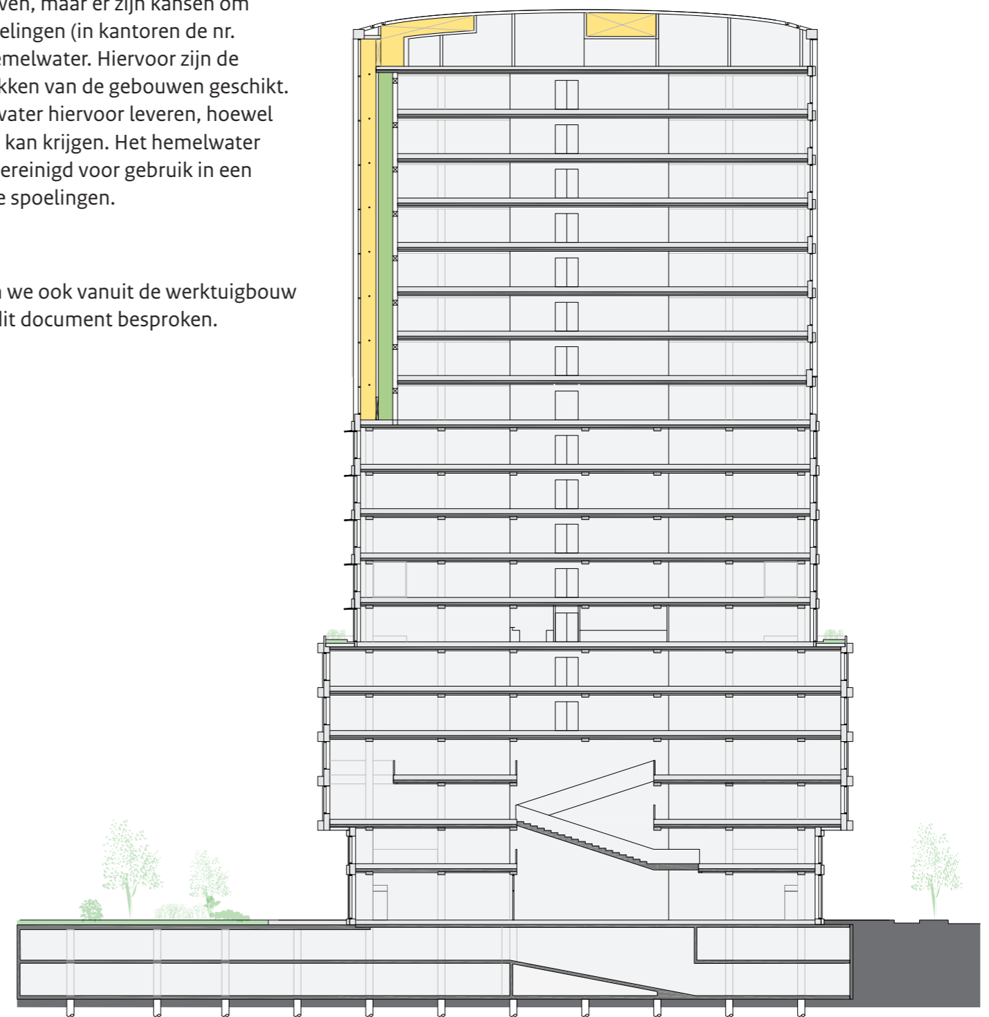
Dwarsdoorsnede met zonneshoorsteen EWF systeem
